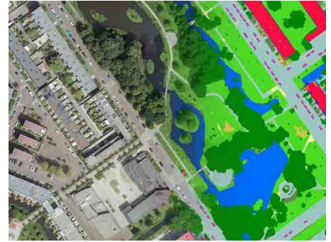
Phân loại đất tự động dựa trên AI được trích xuất từ một bức ảnh trực giao.
