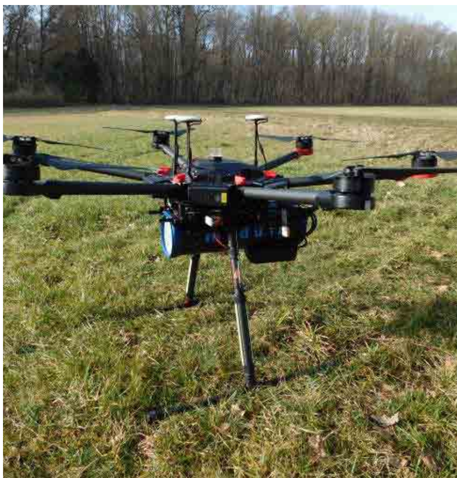
Hình 4: Máy đo phổ tia gamma MS-1000 gắn dưới máy bay không người lái DJI M600 thương mại tiêu chuẩn.
