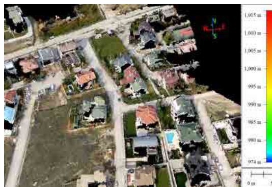
Hình 2: Đám mây điểm 3D trong Quick Terrain Modeller và DSM trong Global Mapper.
